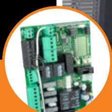
Centrale di comando.
